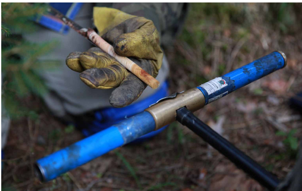
Rycina 7.2. Pobieranie próby dendrochronologicznej (wywiertu) za pomocą świdra przyrostowego (fot. K. Pilch)
