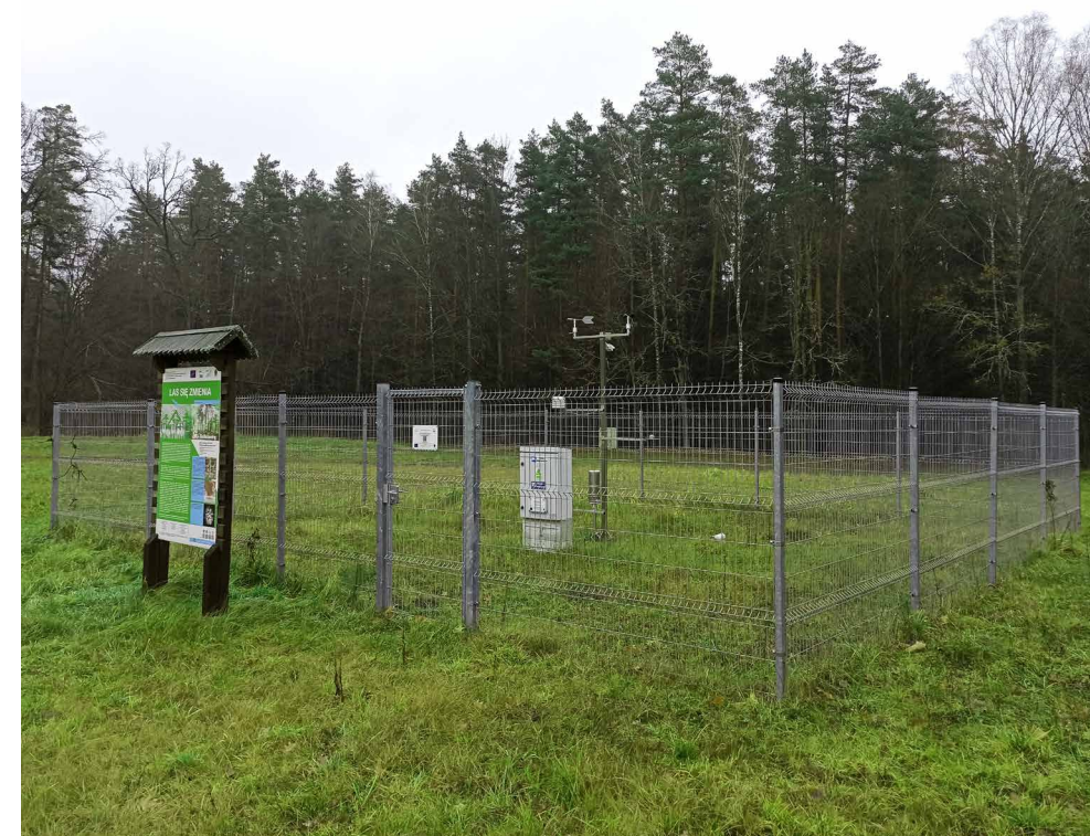
Rycina 3.9. Stacja meteorologiczna w uroczysku Jagiellońskie założona w ramach projektu ForBioSensing (fot. K. Pilch)
