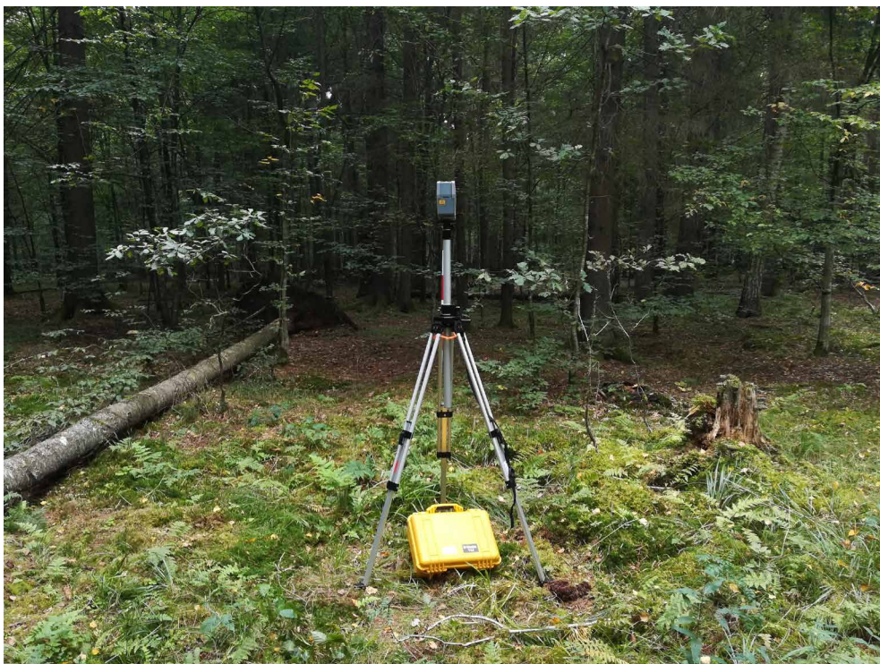
Rycina 10.2. Skaner fazowy Trimble TX5 w trakcie wykonywania skanu na powierzchni taksacyjnej (fot. Kamil Pilch)
